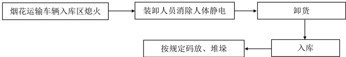
图2-2入库工艺流程框图
